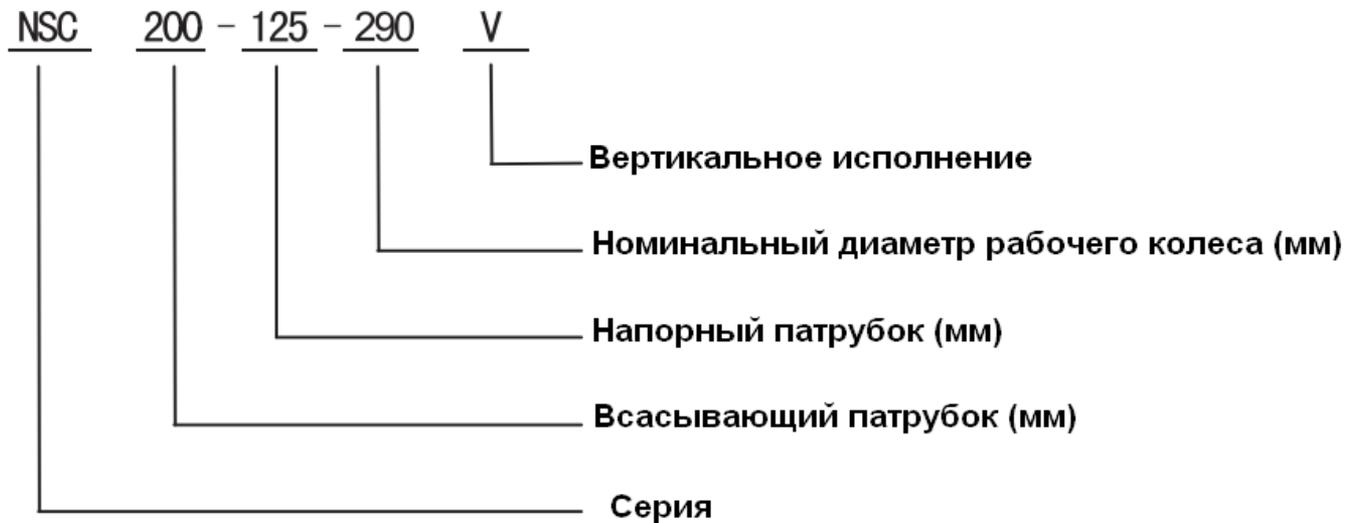
**NSC** – одноступенчатый насос двустороннего входа с осевым разъемом спирального корпуса для горизонтальной и вертикальной установки. Направление вращения вала – по выбору заказчика. Фланцевое соединение по DIN.
